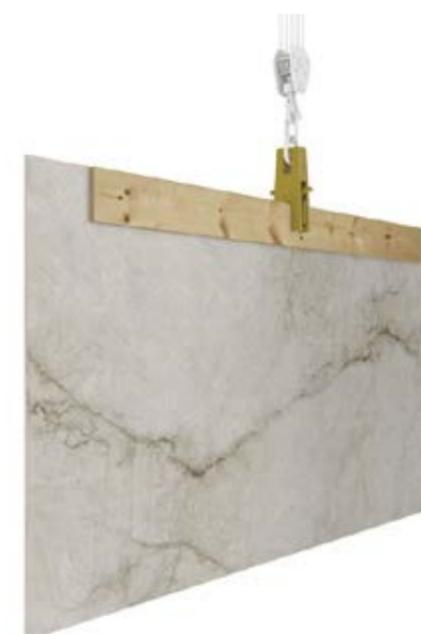
In mancanza di una **pinza** doppia è possibile utilizzarne una **singola**, avendo cura di ampliare il suo piano di ancoraggio con un asse di legno di 300x20x2 cm. L'accorgimento è necessario per evitare movimenti rotatori o torsioni che potrebbero causare la rottura delle lastre.
